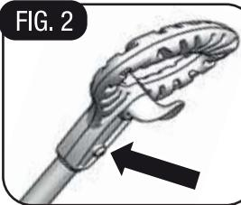
**1.2** Encaixe a haste metálica dentro do puxador até o limite do furo, e parafuse novamente. (Fig. 2 e 3).
