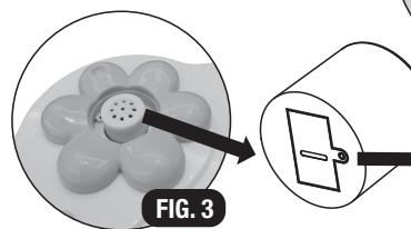
Retire o parafuso da tampa das 3 baterias LR44
