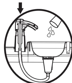
É necessário colocar água (1 copo) na pia e pressionar a torneira várias vezes. A água irá circular da pia para a torneira através de uma mangueira de sucção.
